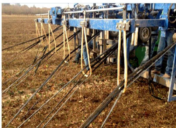
شکل ۴- تصاویری از دستگاه جمع‌آوری کننده نوارهای تیپ از مزرعه Figure 4- Pictures of the tape strips collecting device from the farm
