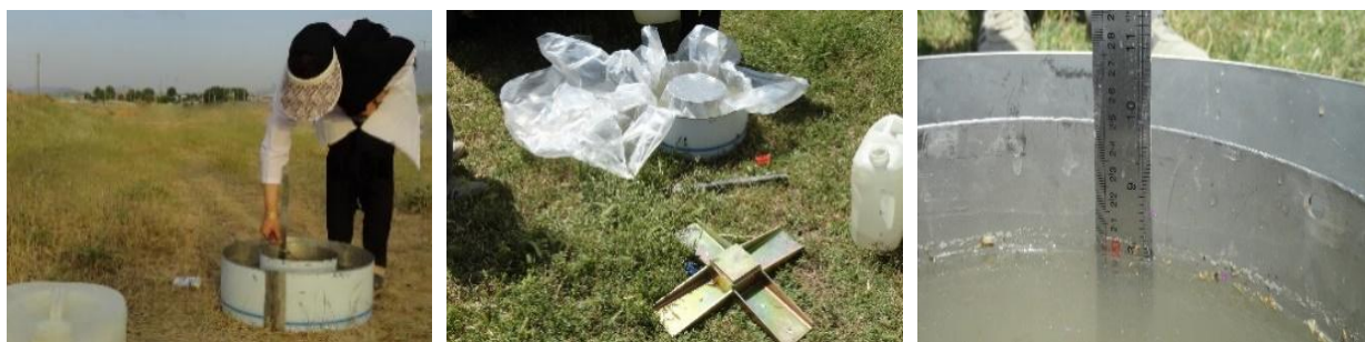
شکل ۳- نمونه برداری صحرائی نفوذپذیری با استفاده از روش استوانه مضاعف Figure 3- Field survey sampling by using double ring method
