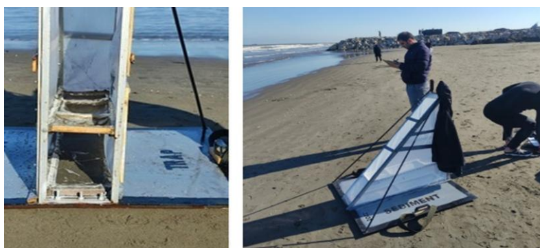
شکل ۲- جزئیات سازه تله رسوب گیر دوفازی
