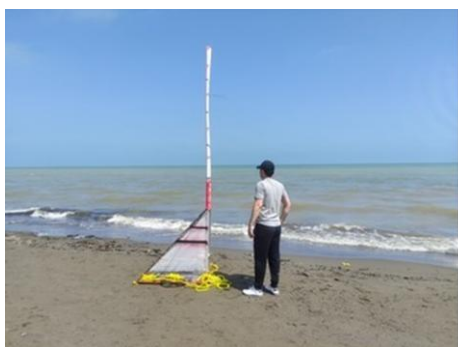
شکل ۳- افزایش ارتفاع دسته رسوب گیر برای نمونه برداری از آب های عمیق تر و استقرار میدانی آن در عمق آب بیش از ۲ متر Figure 3. Extension of the trap handle for deeper water sampling and its field deployment at a water depth exceeding 2 m
