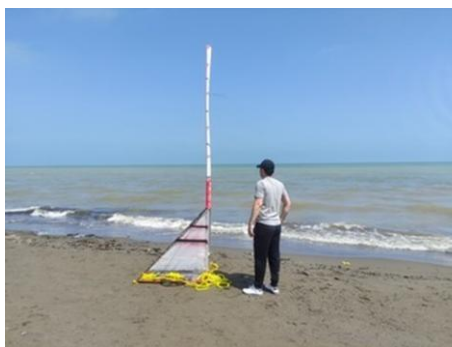
شکل ۳- افزایش ارتفاع دسته رسوب گیر برای نمونه‌برداری از آب‌های عمیق‌تر و استقرار میدانی آن در عمق آب بیش از ۲ متر Figure 3. Extension of the trap handle for deeper water sampling and its field deployment at a water depth exceeding 2 m
