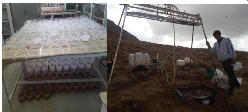
شکل ۲-نمایی از دستگاه شبیه ساز باران و پلات در دامنه قلات و نمونه های رسوب در آزمایشگاه
