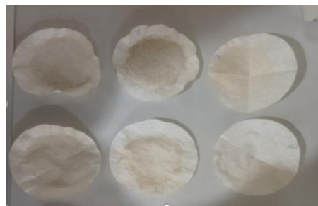
شکل ۵- پساب عبور داده شده از کاغذ صافی برای اندازه گیری TSS Fig. 5 – Filtrate passed through filter paper for TSS measurement
