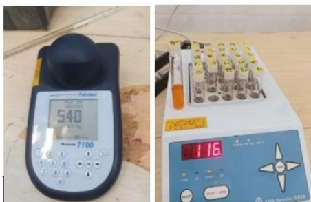
شکل ۴- دایجستر و اسپکتروفوتومتر مربوط به COD متر Fig. 4 – COD digestion unit and corresponding spectrophotometer
