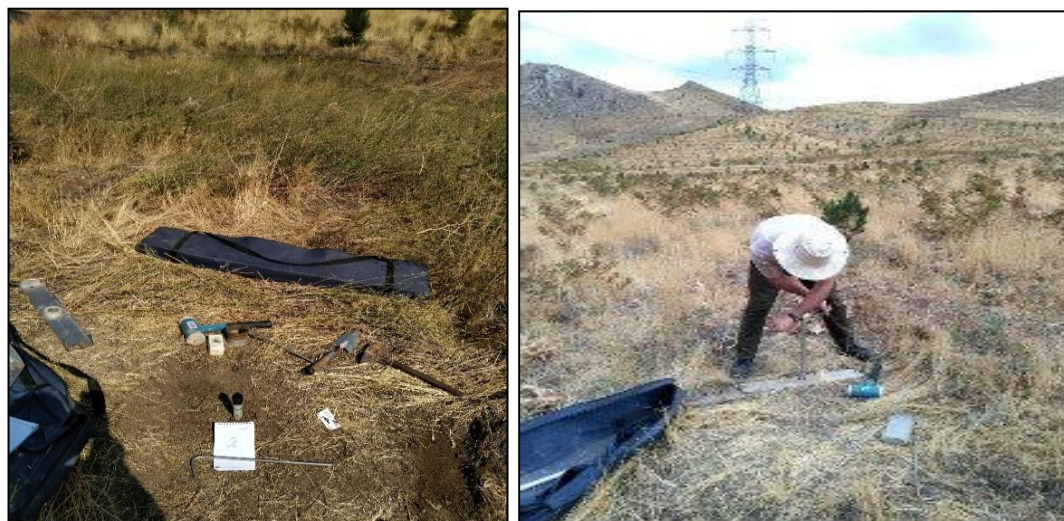
شکل ۴- مراحل نصب تجهیزات اندازه گیری رطوبت خاک در منطقه مورد مطالعه
