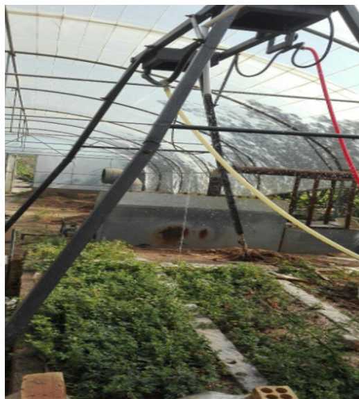
شکل ۱- کرت‌های آزمایشی تحت شبیه‌ساز بارندگی Figure 1- Experimental plots under rainfall simulator
