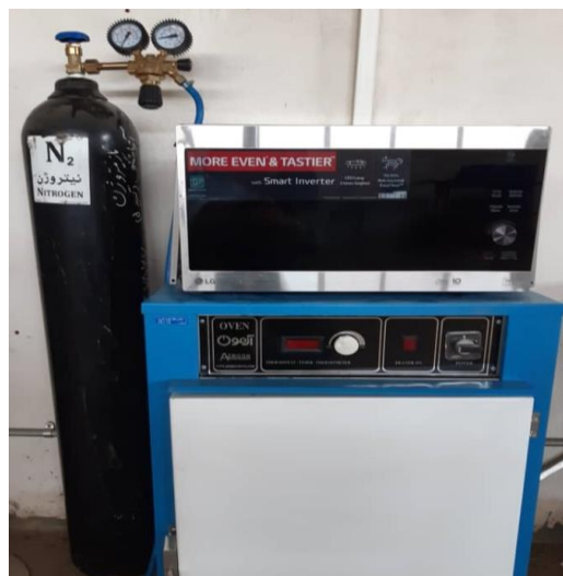
شکل ۳- مایکروفر به همراه کیپسول گاز نیتروژن و آون Figure 3- Microwave with nitrogen gas capsule and oven
