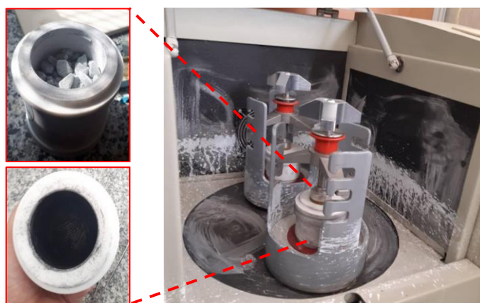
شکل ۲- آسیاب گلوله ای سیاره ای به همراه کاپ نمونه ها Figure 2- Planetary ball mill with sample cup
