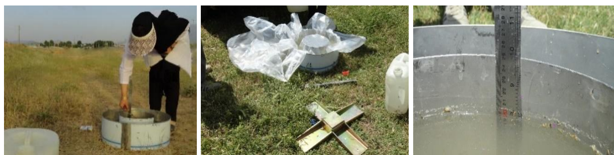
شکل ۳- نمونه برداری صحرائی نفوذپذیری با استفاده از روش استوانه مضاعف
