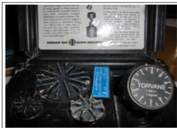
شکل ۳- اندازه‌گیری مقاومت برشی تیمارها (سمت راست) با استفاده از دستگاه Torvane (سمت چپ)
