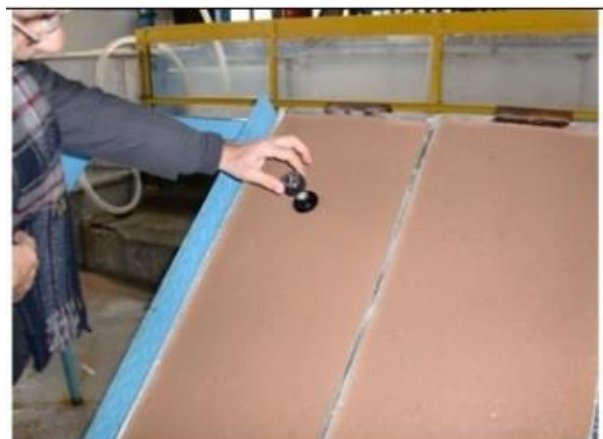
شکل ۳- اندازه‌گیری مقاومت برشی تیمارها (سمت راست) با استفاده از دستگاه Torvane (سمت چپ)
